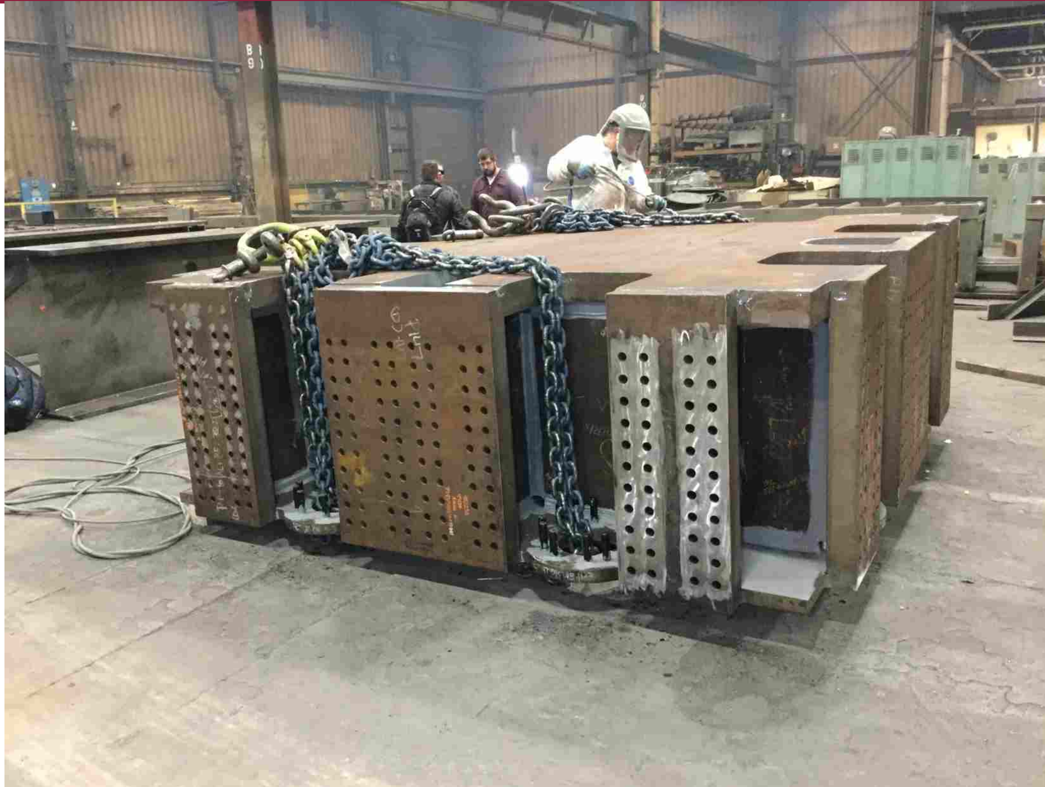
Fabrication de piédestal de type 7 dans l'atelier du Wisconsin
